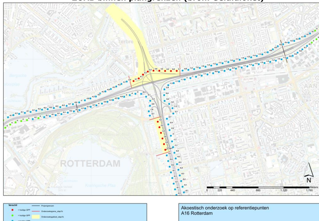
Afbeelding 5.4. Samenvatting GPP-toets aansluiting A16 Rotterdam met A20 en bestaande A16 (Terbregseplein) met tweelaags ZOAB binnen plangrenzen (bron: Geluidloket)
