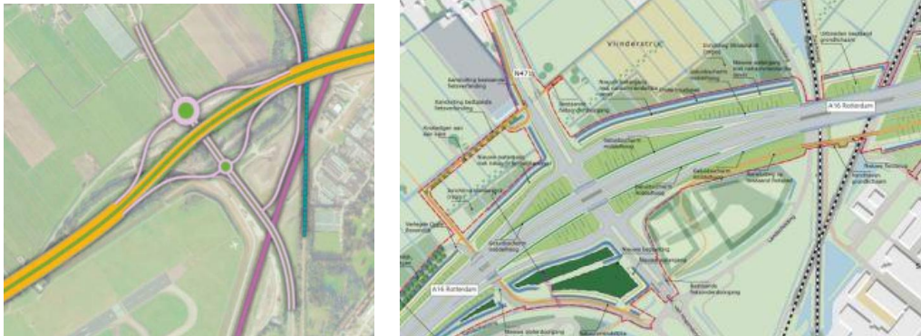
Afbeelding 3.4. Noordelijke verplaatsing aansluiting N471 MER variant TB ontwerp
